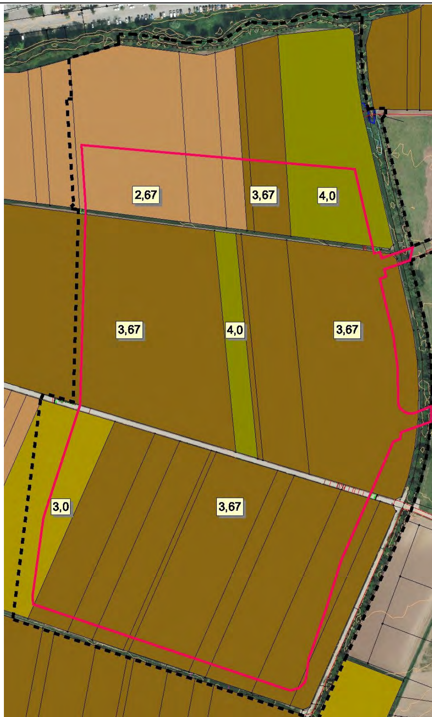
Abb. 12 Gesamtbewertung Boden (ohne Maßstab), Bau-/Versiegelungsbereich (rot)
